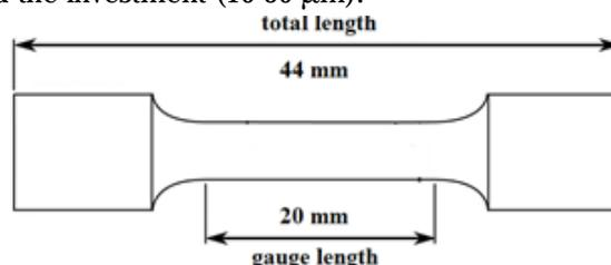
Fig.1. Tensile specimen
